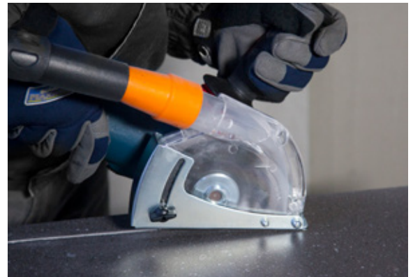
Dammfri kapning med dammutrug.
