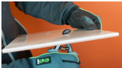
Papegojtång med bockade käftar för t.ex. håltagning.
