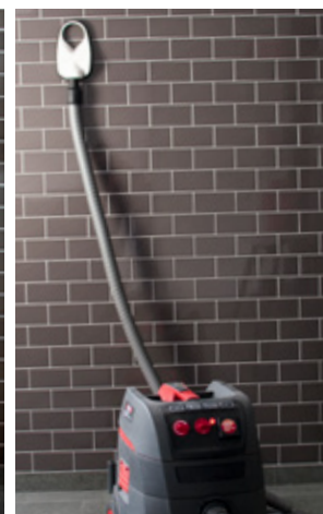
Sugs fast mot underlaget vid anslutning till dammsugare.
