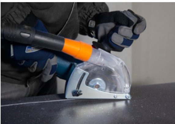
Dammfri kapning med Dammutsug för vinkelslip.
