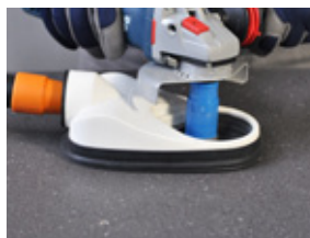
Dammfri håltagning för borrar med Ø 1-72 mm.
